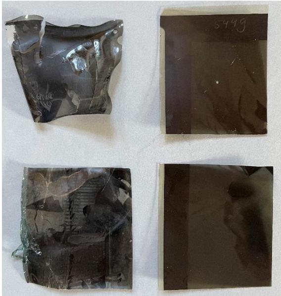
Figure 4 Négatifs en acétate de cellulose à gauche et négatifs en nitrate de cellulose à droite, après le sauvetage, © S. Mateos
