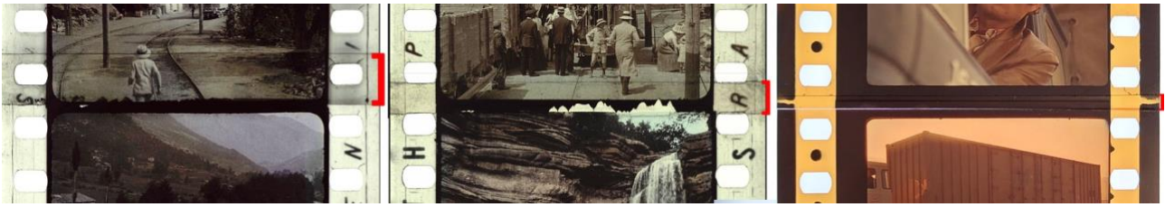
Abb. 3: Nassklebestellen, links mit grosszügigem Überlapp von einer Perforation, wie bei einem Film aus den 1910er Jahren zu erwarten ist. In der Mitte eine spätere Ausführung mit weniger Überlapp. Rechts minimaler Überlapp bei einer modernen Nassklebestelle an einem Zwischenpositiv.
