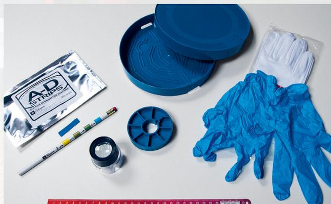
Il righello e la lente di ingrandimento sono strumenti utili per ispezionare le pellicole. Guanti, strisce A-D, custodie e nuclei di avvolgimento si possono richiedere presso la Lichtspiel.
