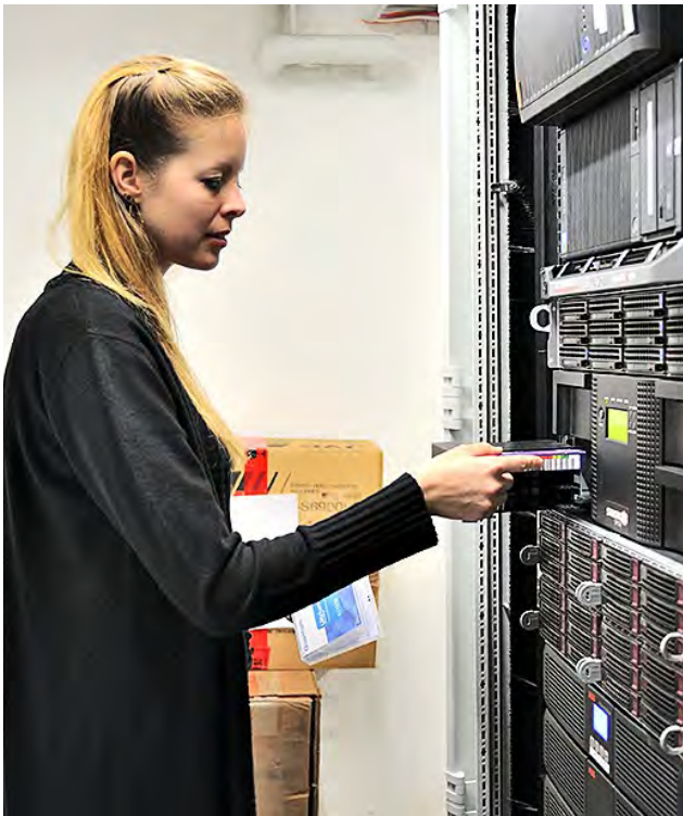
Una collaboratrice di SAPA che rimuove una cassetta LTO dalla memoria di massa. Foto: Rudolf Müller / Memoriaiv
