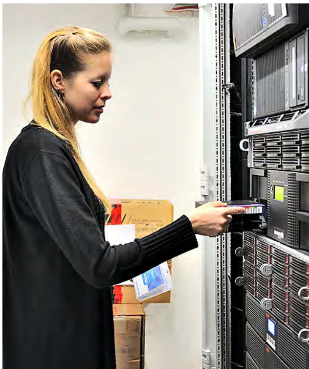
Eine Mitarbeiterin von SAPA beim Entnehmen einer LTO-Kassette aus dem Massenspeicher. Foto: Rudolf Müller / Memoriaiv
