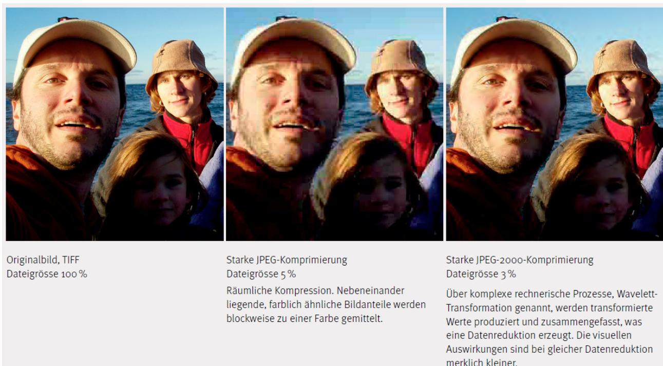
Abb. 1: Visuelle Konsequenzen der JPEG- und der JPEG-2000-Kompression.
