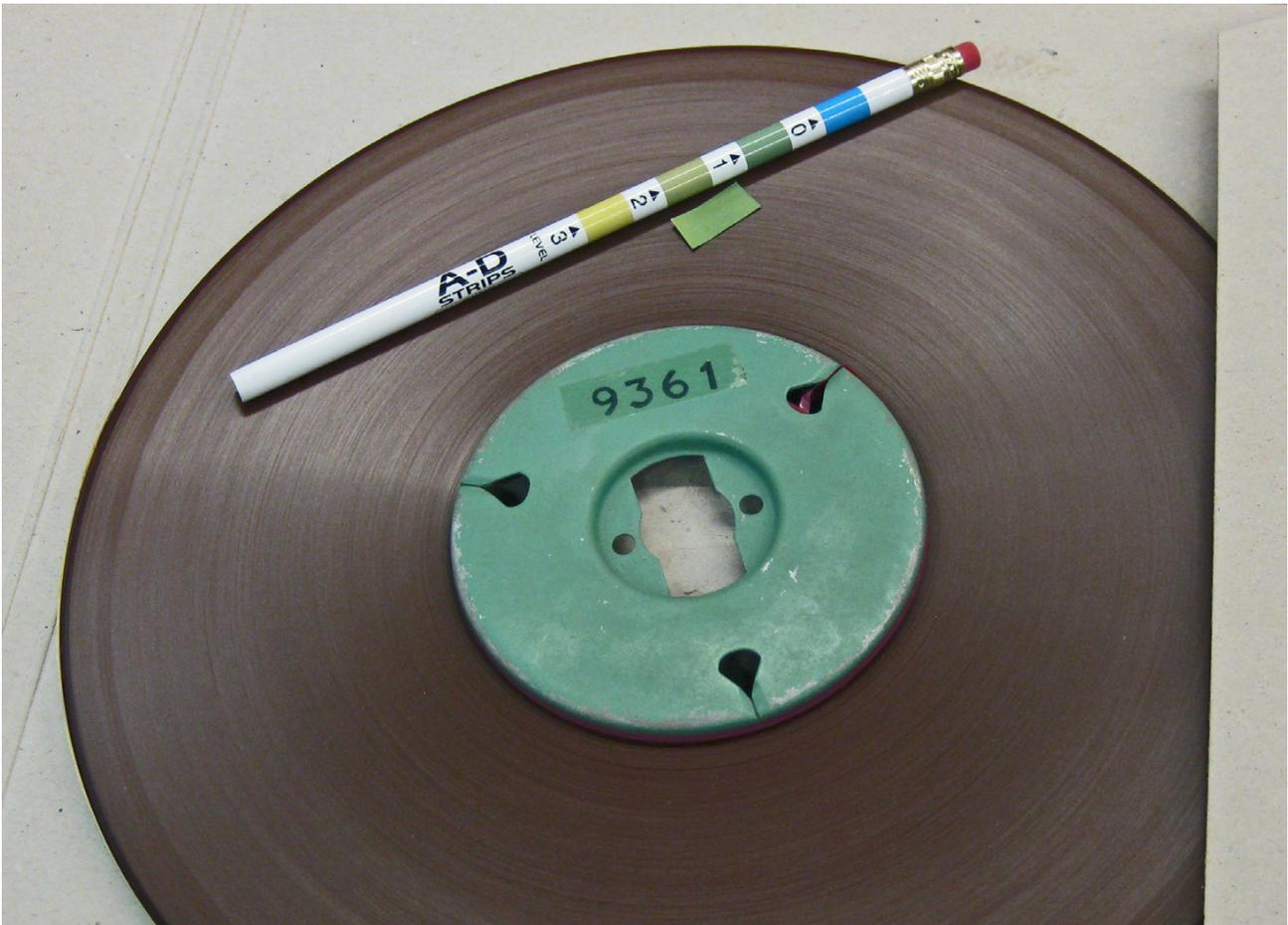
Der Säuregehalt der Bänder kann mit Hilfe der mitgelieferten Farbskala einfach bestimmt werden. Im abgebildeten Beispiel beträgt er 1,8. Das bedeutet, dass ein beschleunigter Zersetzungsprozess im Gang ist. Foto: Ruedi Müller
