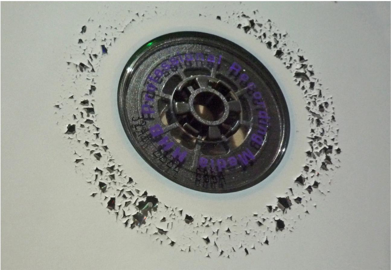
Die Qualität von CD-R-Rohlingen differiert selbst beim gleichen Hersteller je nach Produktionscharge erheblich. Im Bild ein mangelhafter CD-R-Rohling, der sich bereits nach vier Jahren in seine Bestandteile auflöste. Foto: Ruedi Müller
